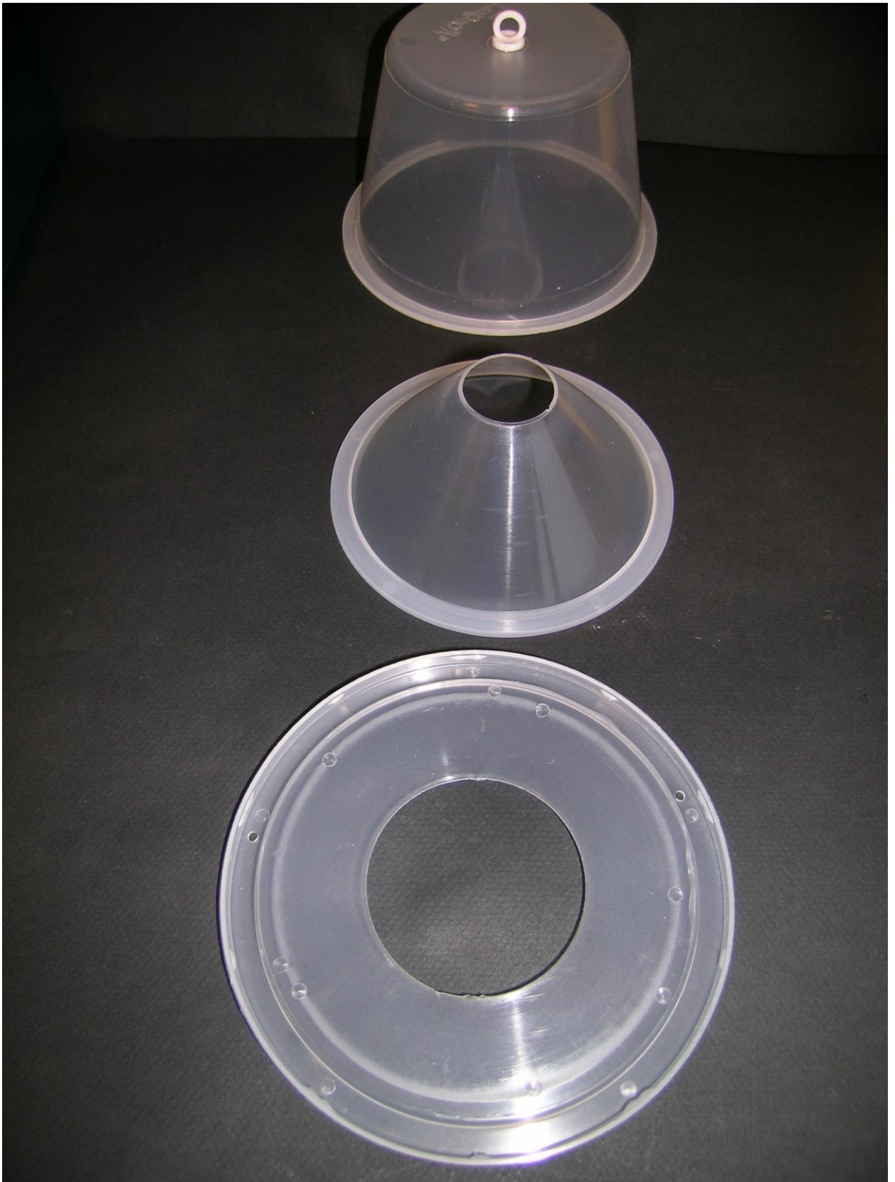
2 pav. Kūgio gaudyklės sudedamosios dalys (iš viršaus į apačią) – kepurėlė, nupjautas kūgis, žiedas (Henriko Ostrausko nuotrauka)
