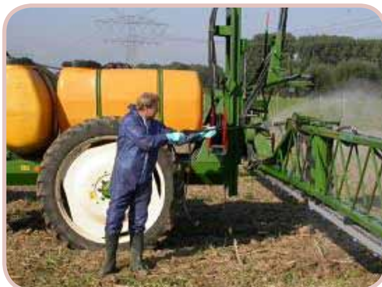
16 pav. Purkštuvų išorės plovimas purškiamame lauke
